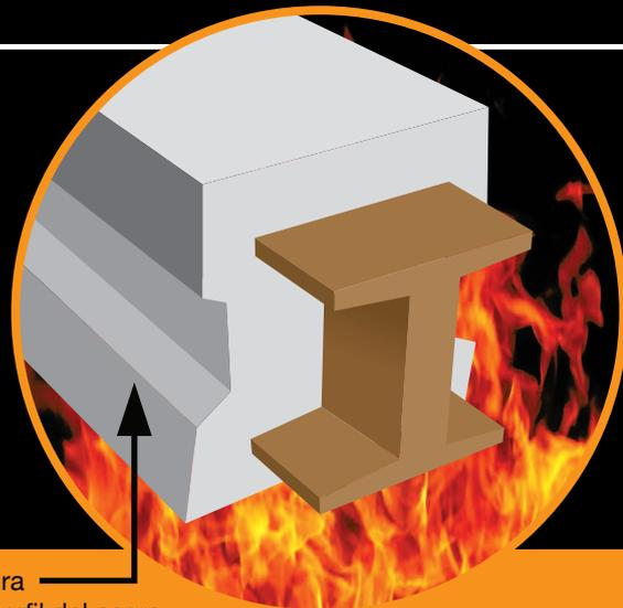
Expansión de la pintura intumescente en un perfil del acero debido al efecto del calor
